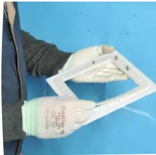
Coloque a junta sobre o flange
