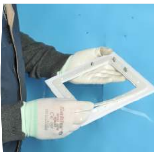
Posizionare il giunto sopra il traversino
